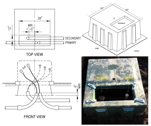
Figure 4.19 – Conduit Entrance Single-Phase Transform
